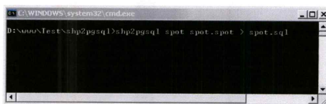
รูปที่ 4.6 แปลงข้อมูลจาก shape เข้าสู่ภาษา SQL
