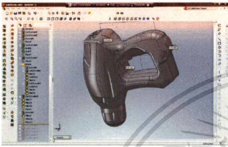
19. ใช้คำสั่ง Extrude สร้างส่วนต่างๆให้ครบ เช่นปุ่ม และฐานของช่องสายไฟ
