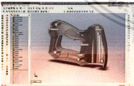
23. ใช้คำสั่ง Extrude cut เจาะส่วนของปุ่มต่างๆให้เรียบร้อย
