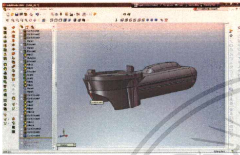
75. ใช้คำสั่ง Extrude cut ตัดส่วนหน้า
