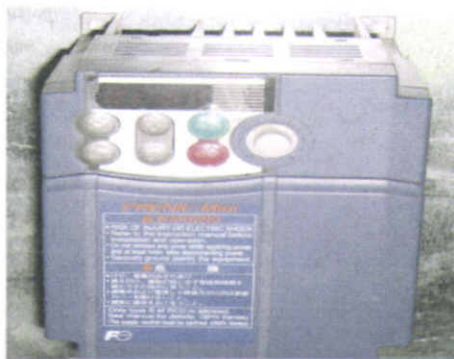
รูปที่ 5.8 อินเวอร์เตอร์ควบคุมความเร็วมอเตอร์ 3 เฟส
