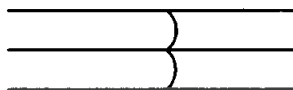
รูปที่ 2.13 ก. ลัดวงจร three-phase fault แบบไม่ลง Ground
