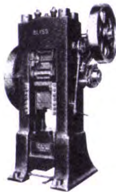
ภาพที่ 135 เครื่องกดแบบข้อต่อร่วมขนาด 150 ตัน
