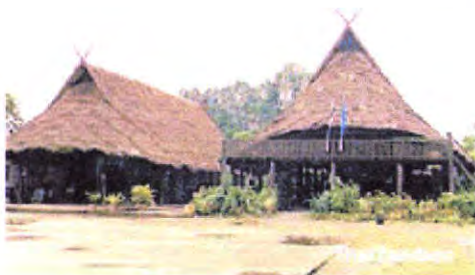
ภาพที่ 18 บ้านไทด้า ยกพื้น สูง หลังคาคลุมตัวบ้าน
