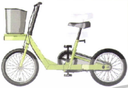
สามารถปรับระดับบอร์นและบาะที่นั่งได้เหมาะตามระดับความสูงของผู้ขับขี่
