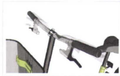
สามารถปรับระดับมือจับเพื่อปรับระยะเอ้ามให้พอดีกับผู้ขับขี่
