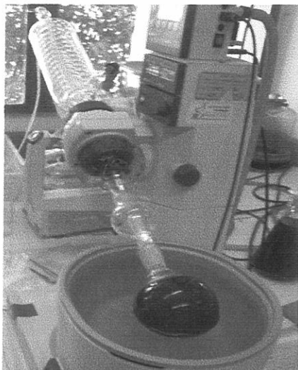
ภาพผนวกที่ 1 แสดงเครื่อง Evaporator
