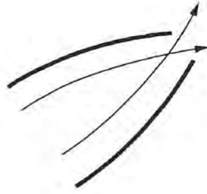
ภาพที่ 22 ภาพแสดงการไหลของน้ำผ่านพวยกาที่ไม่ถูกต้อง
