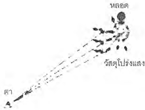
ภาพที่ 2.6 – 6 แสดงวิธีการลดแสงจ้าโดยใช้วัสดุโปร่งแสง
