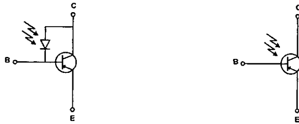
รูปที่ 2.4 วงจรสมมูลและสัญลักษณ์ของไฟโตรีานซิสเตอร์
