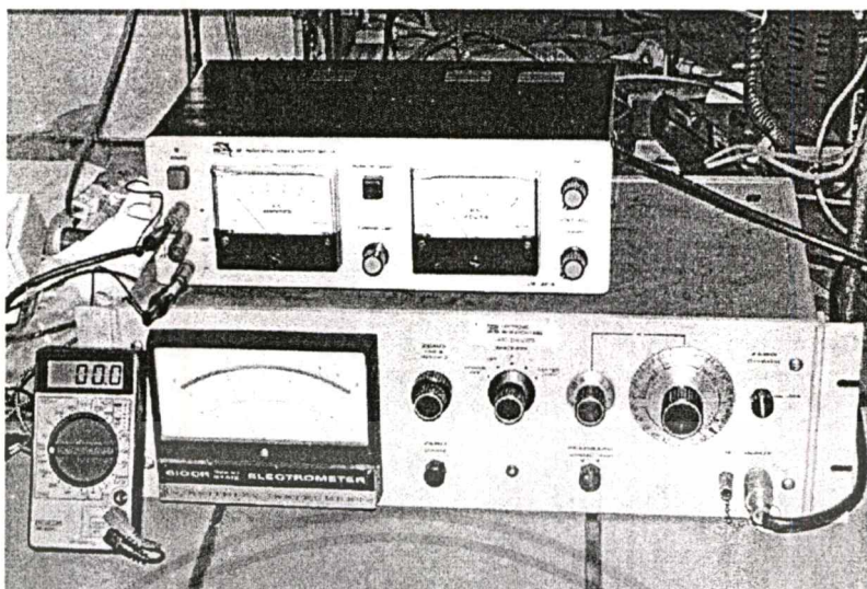
รูปที่ 3.3 แสดงชุดอุปกรณ์ที่ใช้วัดค่าความต้านทานแผ่นและสภาพต้านทานไฟฟ้า
