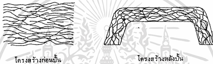
ภาพที่ 2.29 แสดงผลของการอัดตัวที่มีต่อโครงสร้างของโพลีเอททีลีนชนิดเส้นตรง (linear) และชนิดแตกกิ่ง (Branched)
