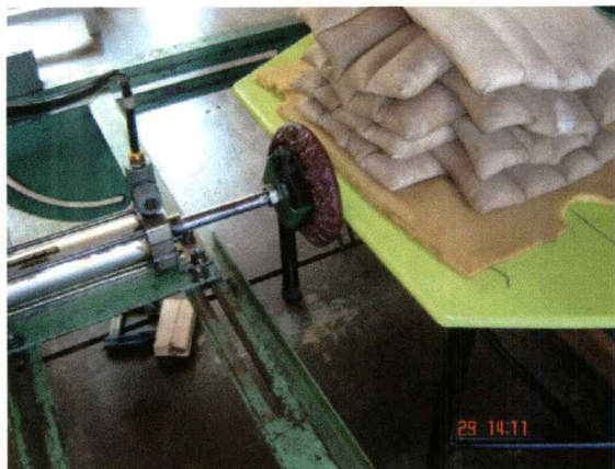
ภาพที่ ค.8 แสดงการทดสอบความล้าเนื่องจากแรงกระทำในแนวระดับ
