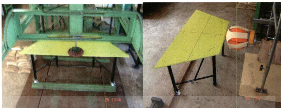
ภาพที่ ค.2 แสดงการทดสอบเสถียรภาพของโต๊ะ
