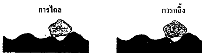
รูปภาพที่ 2.15 แสดงลักษณะการเคลื่อนที่สัมพัทธ์แบบการไถลและแบบกลิ้ง
