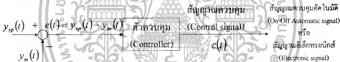
รูปที่ 3.10 ลักษณะของสัญญาณที่จะเข้าสู่ตัวควบคุม(Controller)
