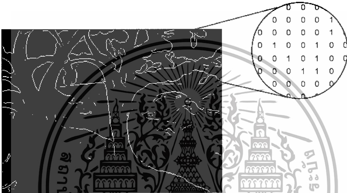
รูปที่ 2.10 พิกเซลในไบนารีของรูปภาพมีค่าที่เป็นไปได้สองค่า คือ 0 หรือ 1
