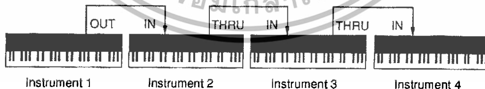
รูปที่ 2.5 การส่งข้อมูลมิดี แบบลูกโซ่โดยอุปกรณ์ 1 เป็นตัวส่งและอุปกรณ์ 2, 3 และ 4 เป็นตัวรับ
