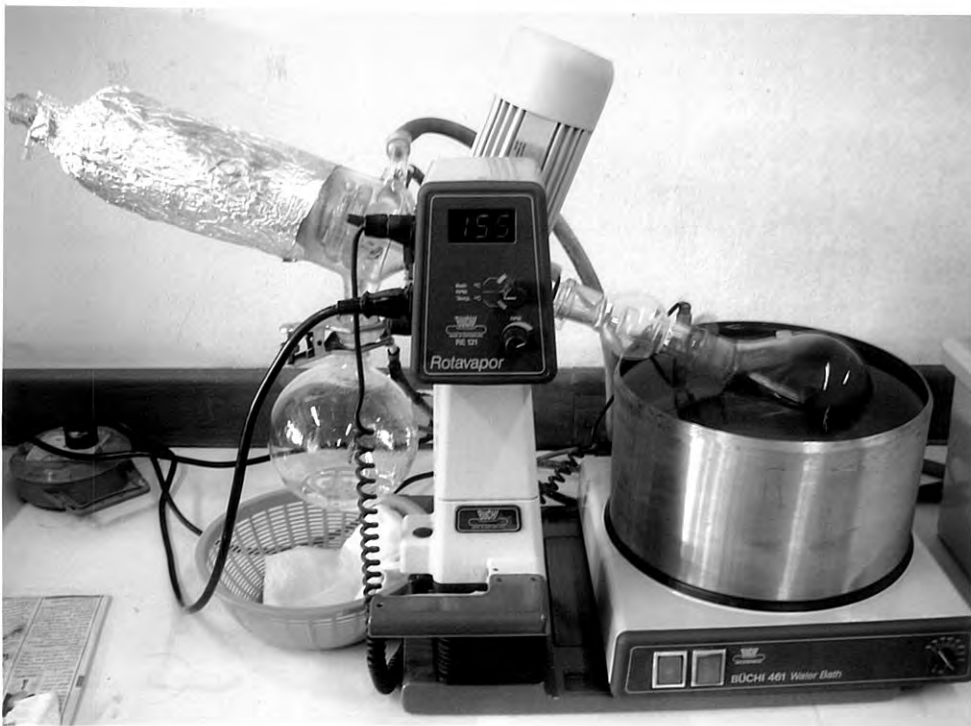
เอกสารนี้เป็นเอกสารที่สงวนไว้สำหรับการใช้งานเพื่อการศึกษาเท่านั้น ไม่อนุญาตให้นำไปใช้ประโยชน์ด้านการค้า ไม่ว่ากรณีใดๆทั้งสิ้น อีกทั้งห้ามมิให้ดัดแปลงเนื้อหา และต้องอ้างอิงถึงเจ้าของเอกสารทุกครั้งที่มีการนำไปใช้ ภาพที่ 9 เครื่อง rotary vacuum evaporator ยี่ห้อ Buchi รุ่น RE121
