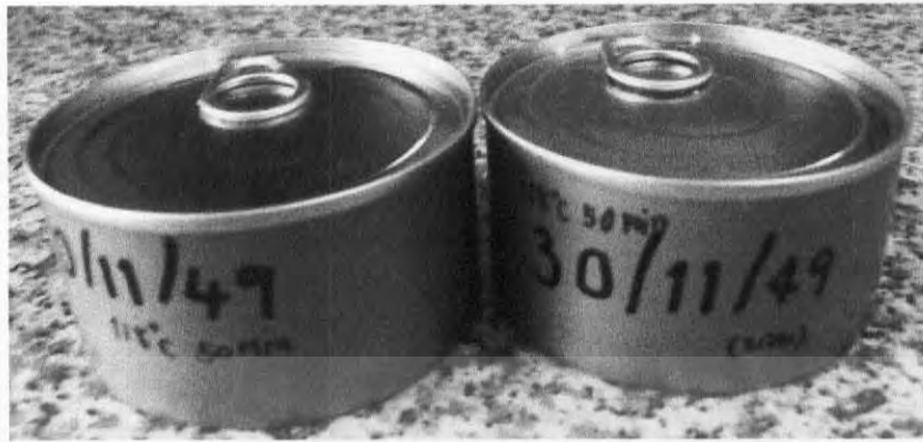
รูปที่ 4.2 ลักษณะของฝากระป๋องที่เว้า (ซ้าย) และพองขึ้นเล็กน้อย (ขวา)
