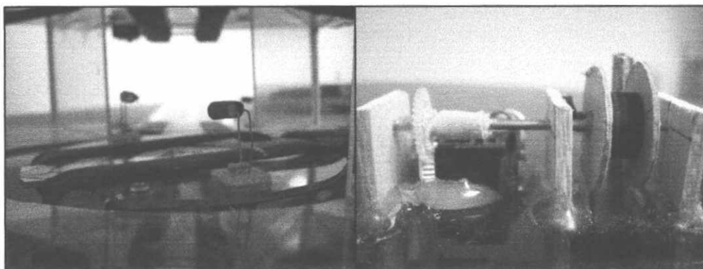
รูปที่ 3.9 ลิฟต์ยกและระบบขับเคลื่อนลิฟต์ยก
