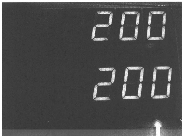
รูปที่ 4.11 จอแสดงผล 7-SEGMENT แสดงค่าเมื่อรถทุกคันออกจากชั้นที่หนึ่งและชั้นที่สอง
