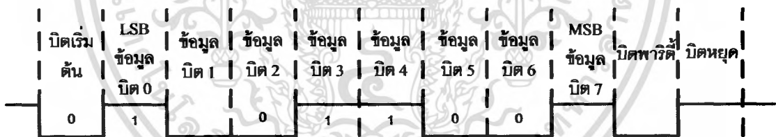
รูปที่ 2.53 การสื่อสารข้อมูลแบบอะซิงโครนัส
