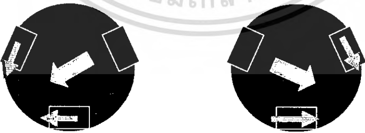
รูปที่ 7-4 แสดงลักษณะการถอยหลังเฉียงของหุ่นยนต์
