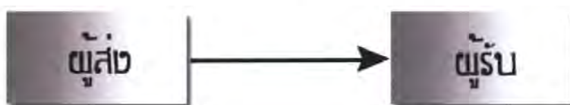
รูปที่ 2.38 แสดงการส่งข้อมูลแบบซิมเพิล็กซ์
