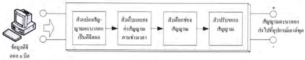
รูปที่ 2.29 ไคอะแกรมของหน่วยเอาต์พุตแบบอนาลอก
