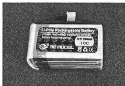
รูปที่ 3.30 แบตเตอรี่ชนิดลิเทียมโพลิเมอร์ความจุ 1800 มิลลิแอมป์
