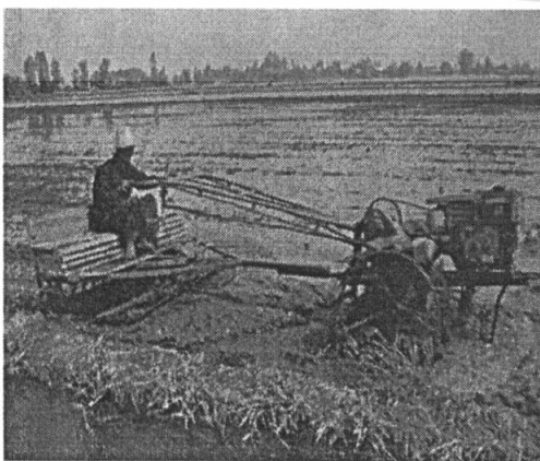
ภาพที่ 2 ขลุบฟ่วงรดไถเดินตามเพื่อการเตรียมดินขั้นที่ 2 (ตีขลุบทำเทือก)
