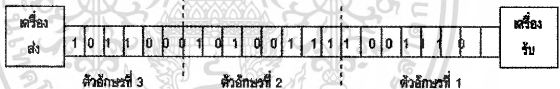
รูปที่ 2.15 การส่งผ่านข้อมูลแบบอะซิงโครนัส
