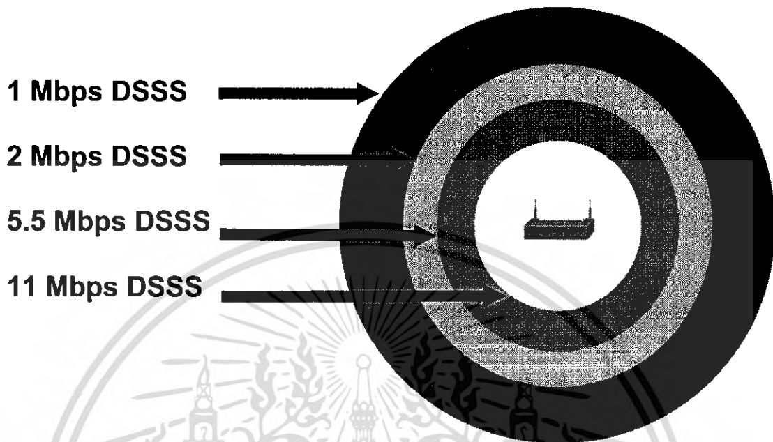
รูปที่ 2.19 พื้นที่ครอบคลุม Access Point
