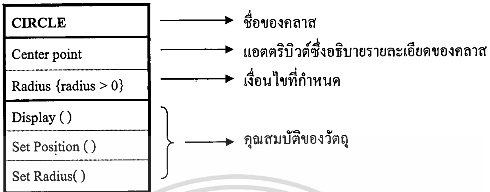
รูปที่ 2.1 ตัวอย่างส่วนประกอบภายในวัตถุชื่อ CIRCLE
