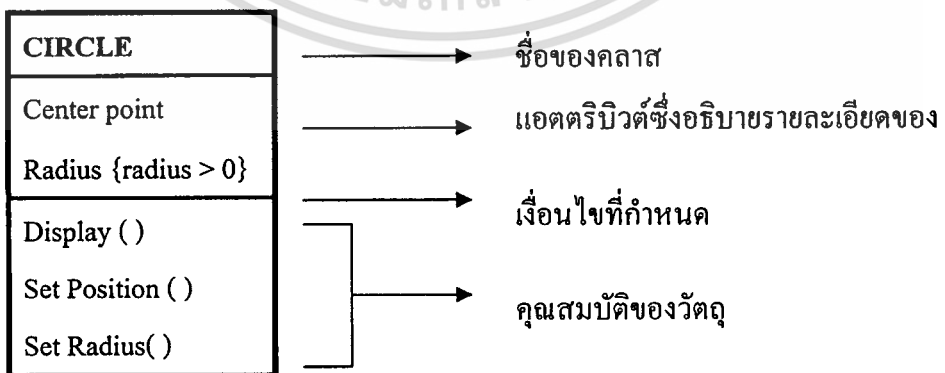
รูปที่ 2.4 ตัวอย่างส่วนประกอบภายในวัตถุชื่อ CIRCLE
