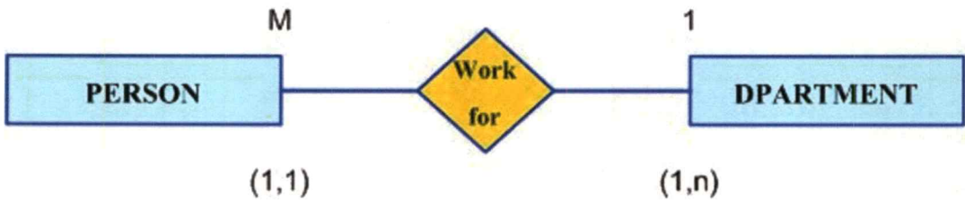
รูปที่ 5.2 รีเลชันชิพระหว่างเอนทิตี PERSON กับ DEPARTMENT
