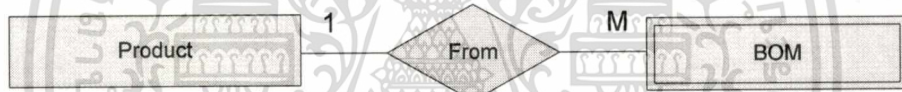
รูปที่ 5.12 ภาพแสดงความสัมพันธ์ระหว่างเอนทิตี Product กับ BOM
