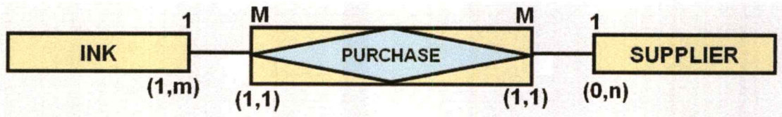
รูปที่ 5.21 คอมโพสิตเอนทิตี PURCHASE ที่แปลงมาจากรีเลชันชิพ bought from
