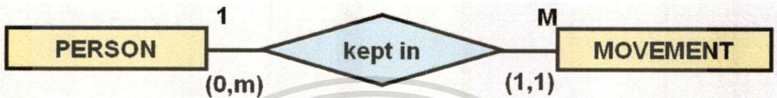
รูปที่ 5.13 รีเลชันชิพระหว่างเอนทิตี PERSON กับ MOVEMENT เมื่อ PERSON เป็นผู้ใช้ใหม่
