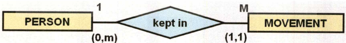
รูปที่ 5.12 รีเลชันชิพระหว่างเอนทิตี PERSON กับ MOVEMENT เมื่อ PERSON เป็นผู้ใช้เดิม
