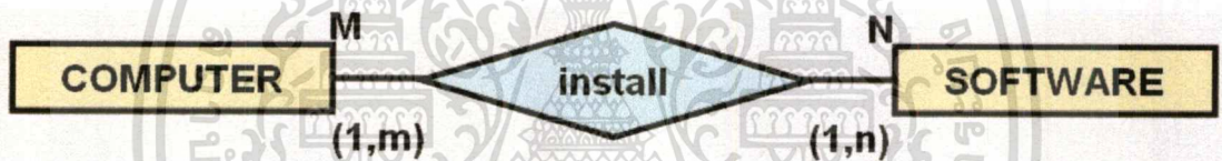
รูปที่ 5.16 รีเลชันชิพระหว่างเอนทิตี COMPUTER กับ SOFTWARE
