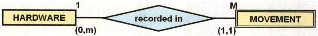
รูปที่ 5.7 รีเลชันชิพระหว่างเอนทิตี HARDWARE กับ MOVEMENT
