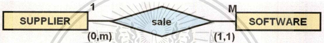
รูปที่ 5.22 รีเลชันชิพระหว่างเอนทิตี SUPPLIER กับ SOFTWARE
