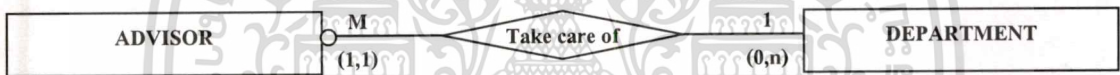
รูปที่ 6.15 ความสัมพันธ์ระหว่างเอนทิตี ADVISOR กับเอนทิตี DEPARTMENT
