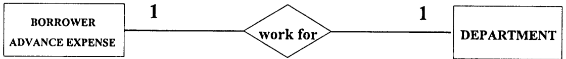
รูปที่ 4.10 แสดงความสัมพันธ์ระหว่าง Entity Borrower advance expense กับ Entity Department
