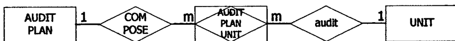
ภาพที่ 4.7 แสดงความสัมพันธ์ระหว่าง AUDITPLAN , AUDITPLANUNIT และ UNIT
