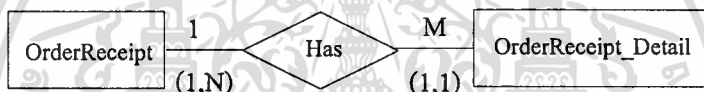
ภาพที่ 5.15 ความสัมพันธ์ระหว่างเอนทิตี OrderReceipt กับ เอนทิตี OrderReceipt_Detail
