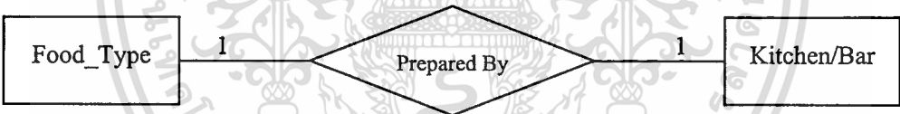
ภาพที่ 4.9 แสดงความสัมพันธ์ระหว่างชนิดอาหารและครัว/บาร์เครื่องดื่ม
