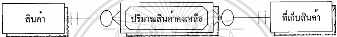
รูปที่ 4.7 ความสัมพันธ์ระหว่างสินค้ากับที่เก็บสินค้าเมื่อกระจายความสัมพันธ์แล้ว
