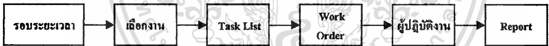
ภาพที่ 2.3 ขั้นตอนการดูแลบำรุงรักษาเชิงป้องกัน
