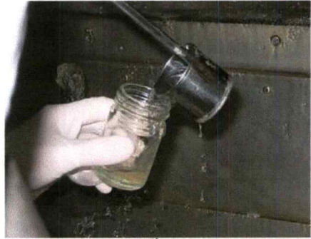
ภาพที่ 4.13 การเก็บน้ำลวกซากจากถังลวก
