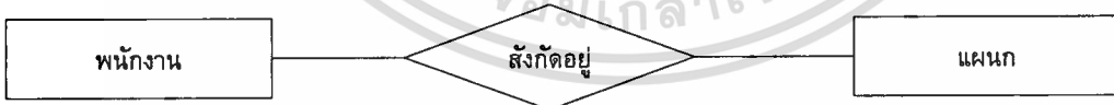
รูปที่ 2.6 แสดงความสัมพันธ์ชื่อ "สังกัดอยู่" ระหว่างเอนทิตีพนักงานกับเอนทิตีแผนก
