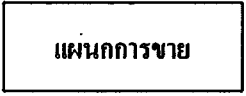
รูปที่ 2.2 สัญลักษณ์แหล่งข้อมูล (Entity Symbol)
