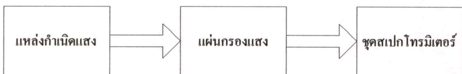
รูปที่ 4.31 การจัดอุปกรณ์สำหรับการวัดการส่องผ่านแสงของแผ่นกรองแสง
