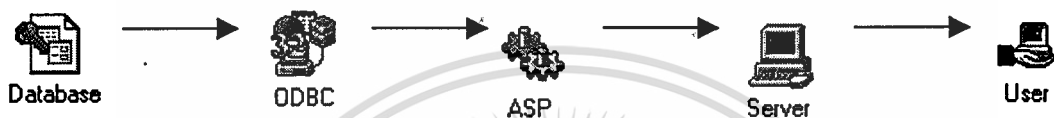
รูปที่ 2.3 การติดต่อระหว่างฐานข้อมูลกับ ASP
