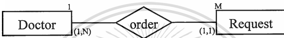
รูปที่ 3.7 ความสัมพันธ์ระหว่าง Entity Doctor กับ Request
