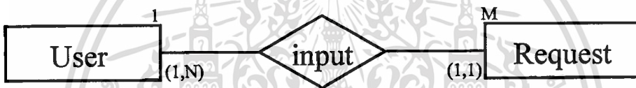
รูปที่ 3.10 ความสัมพันธ์ระหว่าง Entity User กับ Request
