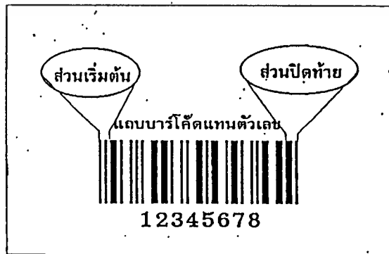
รูปที่ 19 ส่วนประกอบของบาร์โค้ดชนิด Interleaved 2 of 5
