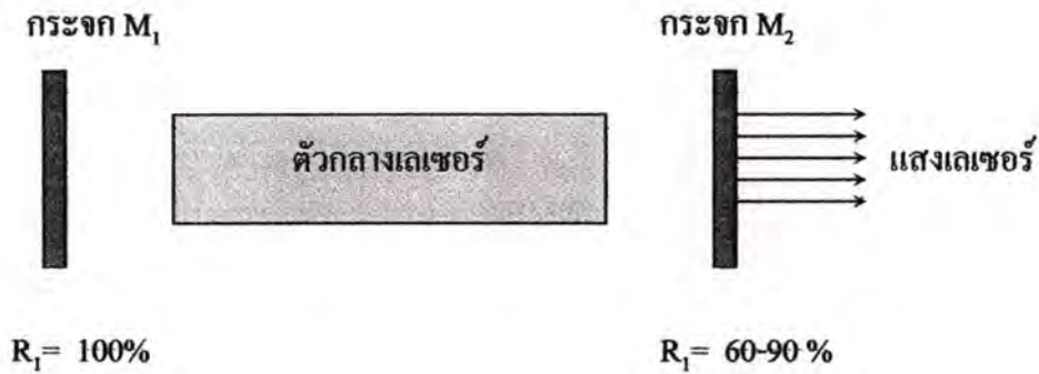
รูปที่ 2.15 โคอะแกรมของเลเซอร์โดยทั่วไป
