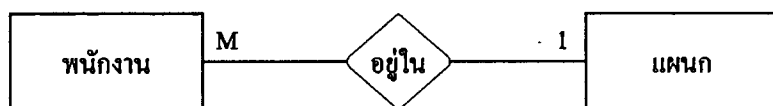
รูปที่ 3.3 ตัวอย่าง E-R Diagram ระหว่างพนักงานและแผนก
