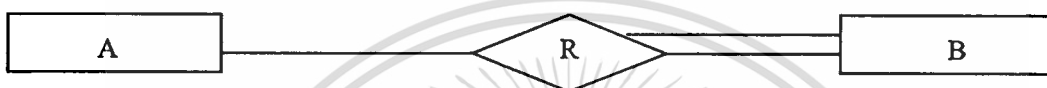
ภาพที่ 2.8 แสดงความสัมพันธ์แบบ Total participation
