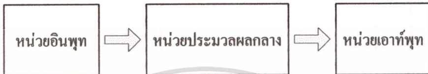
รูปที่ 3.9 แสดงโครงสร้างโดยทั่วไปของเครื่องควบคุม PLC
