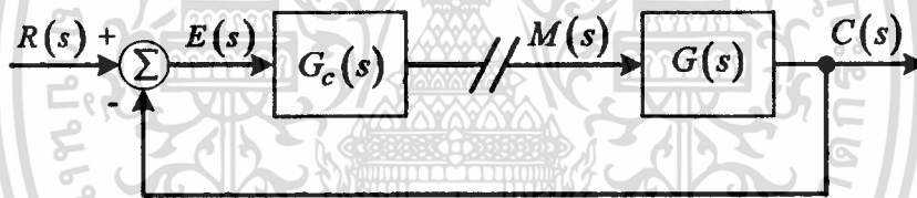
รูปที่ 3.3 แสดงบล็อกไดอะแกรมของการทดสอบกระบวนการแบบรูปเปิด
