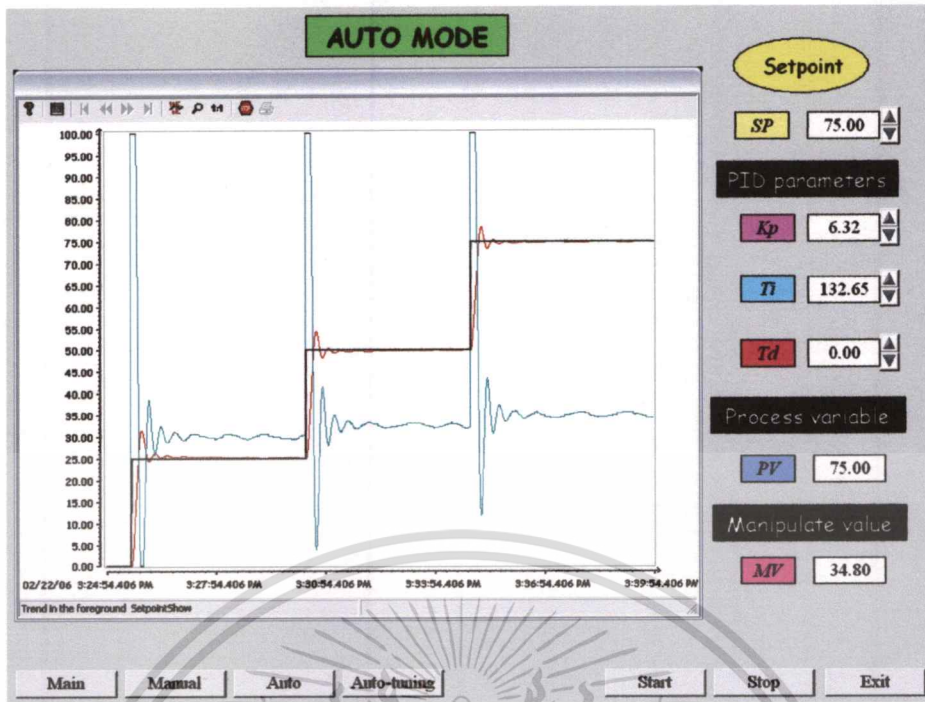
รูปที่ 5.8 แสดงผลตอบสนองของกระบวนการควบคุมระดับน้ำที่ค่าเป้าหมาย 25% และ Step change ไปที่ 50% และ Step change ไปที่ 75% ด้วยการควบคุมแบบพีไอ ( K_p = 6.32 และ T_i = 132.65 sec.)
