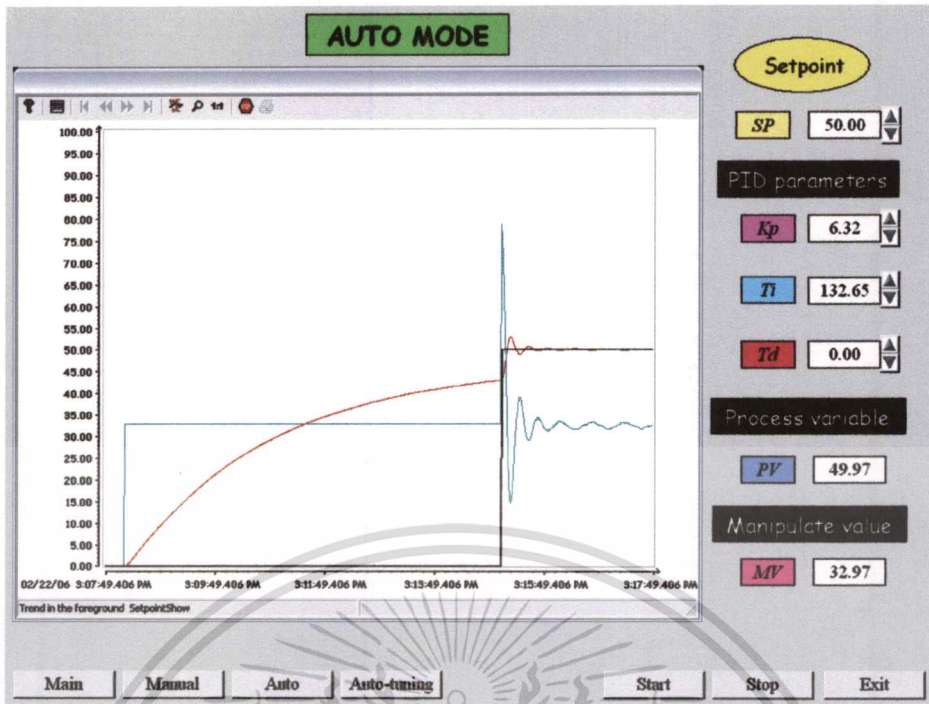
รูปที่ 5.4 แสดงผลตอบสนองของกระบวนการควบคุมระดับน้ำที่ค่าเป้าหมาย 50% หลังจากได้ค่าพารามิเตอร์ของตัวควบคุมแบบพีไอ ( K_p = 6.32 และ T_i = 132.65 sec.)
