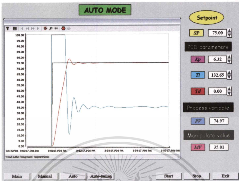
รูปที่ 5.10 แสดงผลตอบสนองของกระบวนการควบคุมระดับน้ำที่ค่าเป้าหมาย 75% ด้วยการควบคุมแบบพีไอ ( K_p = 6.32 และ T_i = 132.65 sec.)
